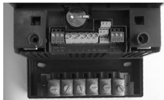
Slave naar links DC AC Sensoren Slave naar rechts L N PE + - L N PE L N PE
